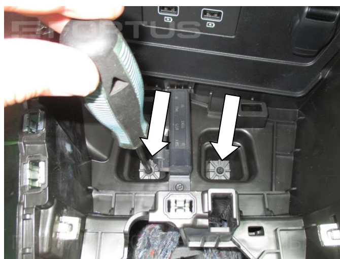
6. Открутите два винта крепления консоли
