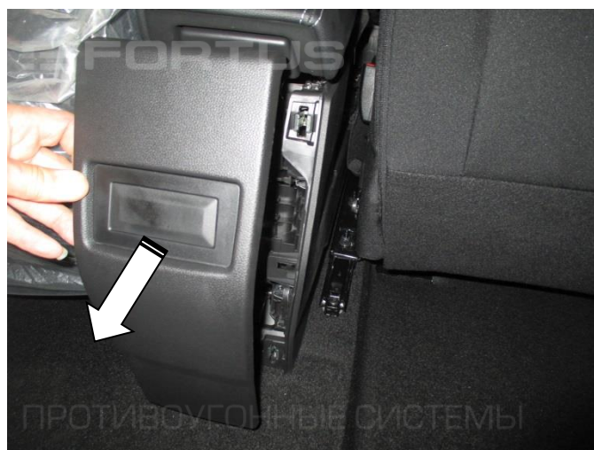
10. Снимите накладку консоли
