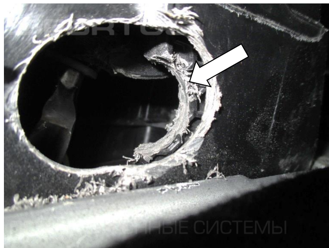
20. Удалите часть пластика стенки крепления тяги
