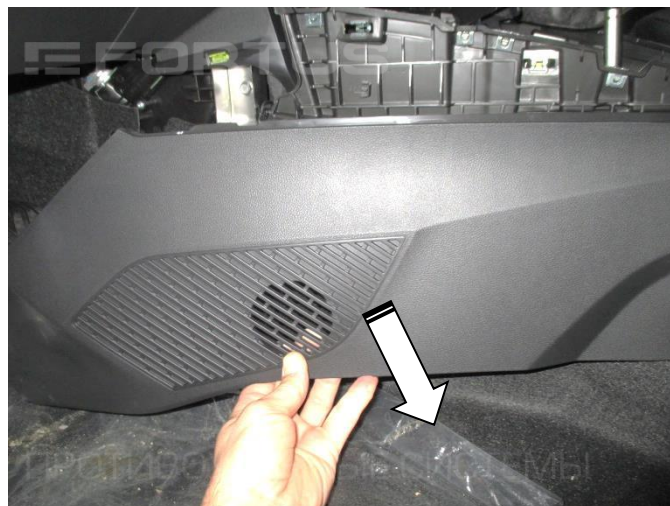
8. Снимите накладку консоли
