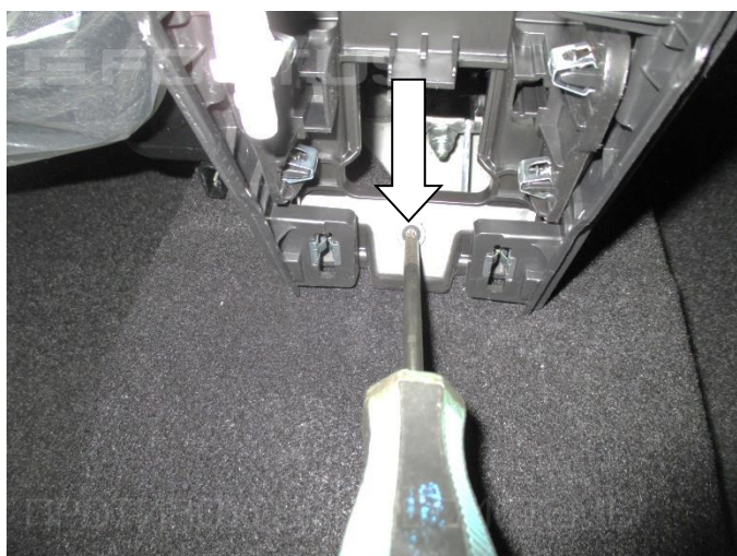
11. Открутите винт крепления консоли
