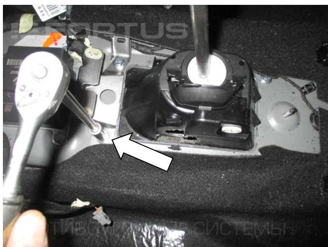
23. Открутите болт крепления селектора
