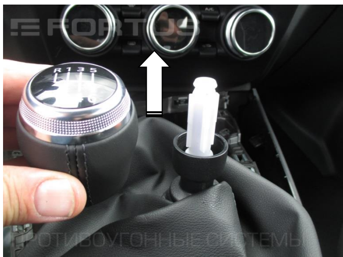
1. Снимите рукоятку рычага КПП
