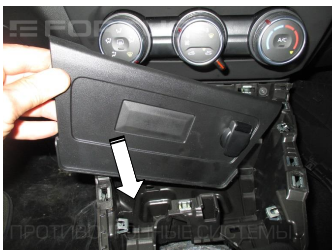
5. Снимите накладку консоли
