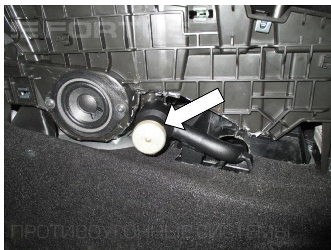
28. Установите шаблон SCH7 на корпус замка
