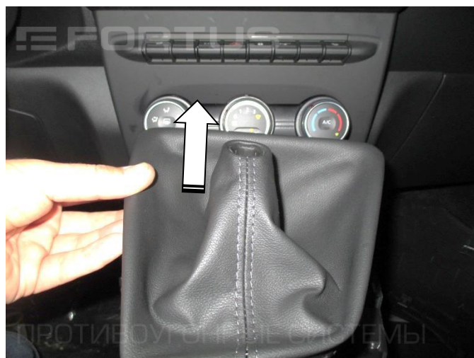
2. Снимите кожаный чехол рукоятки рычага КПП
