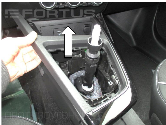
3. Снимите накладку консоли
