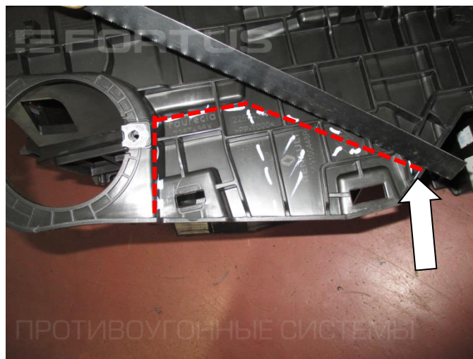
22. Удалите часть пластика консоли под корпус и трубу замка (поз. 1)
