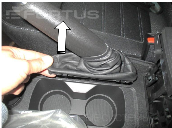
13. Снимите накладку консоли
