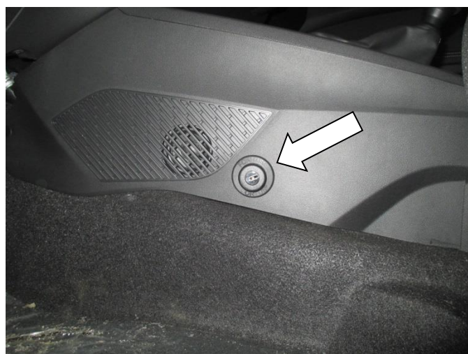
30. Проверьте работоспособность замка, сорвите крепеж, соберите консоль
