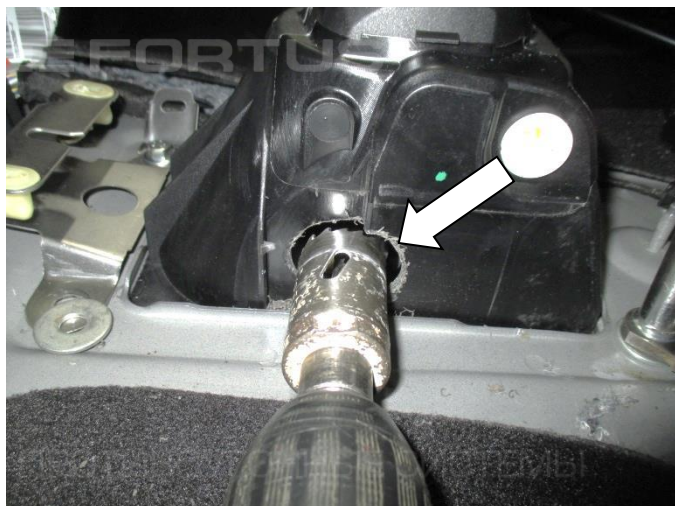
19. Приложите замок (поз. 1) к точкам крепления селектора. Разметьте и просверлите отверстие в стенке селектора под трубу замка \varnothing 32 мм
