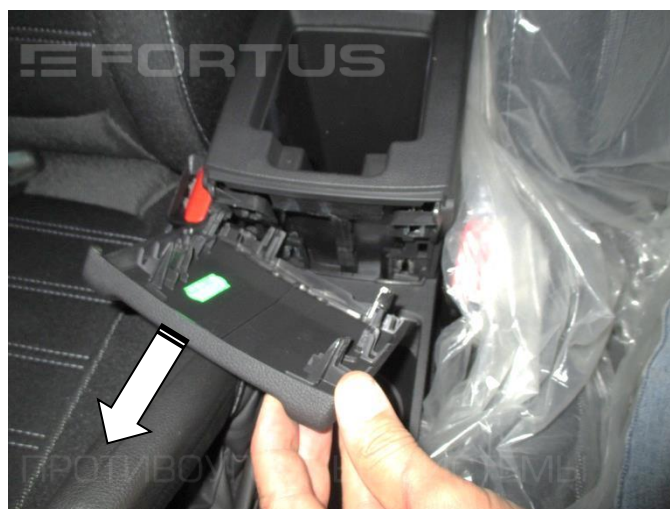
12. Снимите накладку консоли
