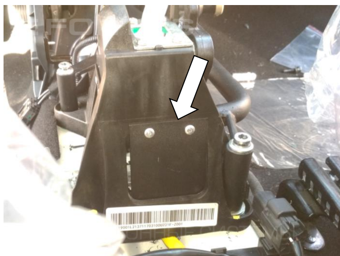
21. Установите пластину (поз. 3), закрепив с помощью заклёпок (поз. 9), используя заклёпочник
