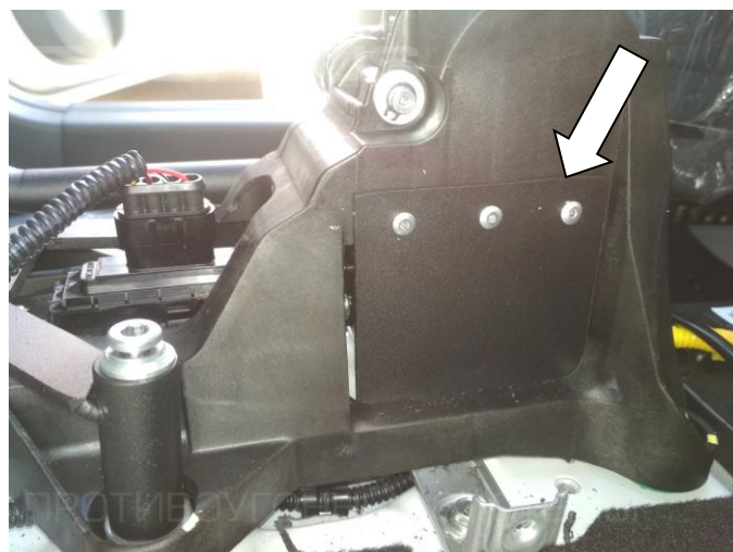
22. Установите пластину (поз. 4), закрепив с помощью заклёпок (поз. 9), используя заклёпочник
