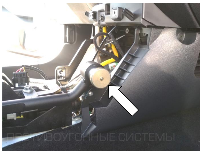
24. Установите шаблон SCH7 на корпус замка
