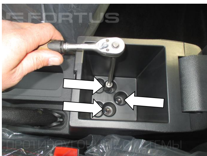
5. Открутите болты крепления консоли
