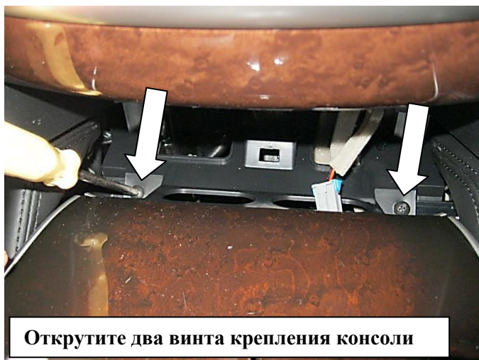
Снимите накладки консоли с обеих сторон
