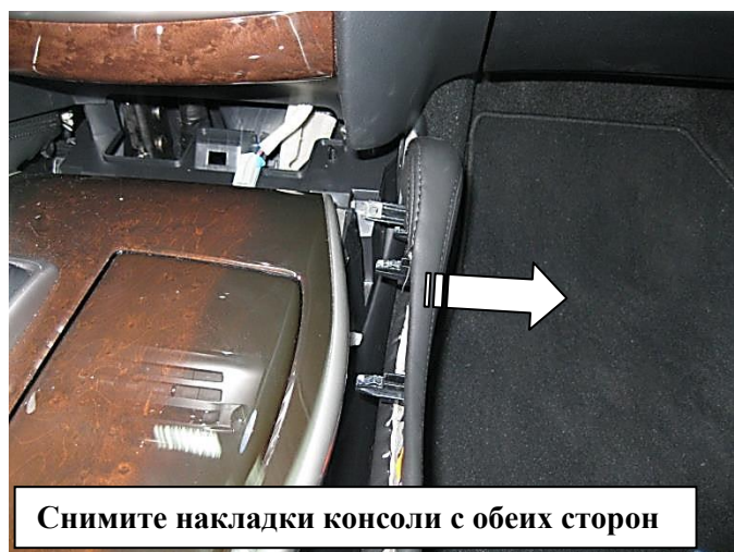
Снимите накладку консоли
