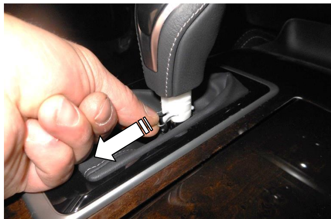
Извлеките фиксатор рукоятки рычага КПП
