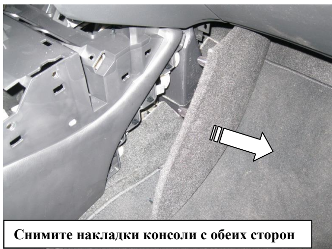
Снимите накладку консоли
