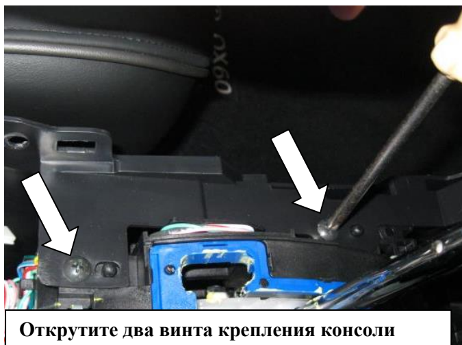
Открутите по одному винту крепления консоли с обеих сторон
