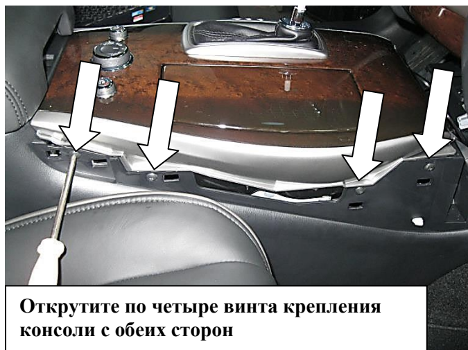
Снимите накладку консоли
