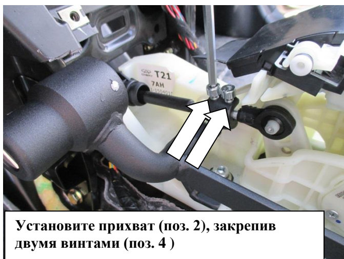
Открутите два болта крепления селектора
