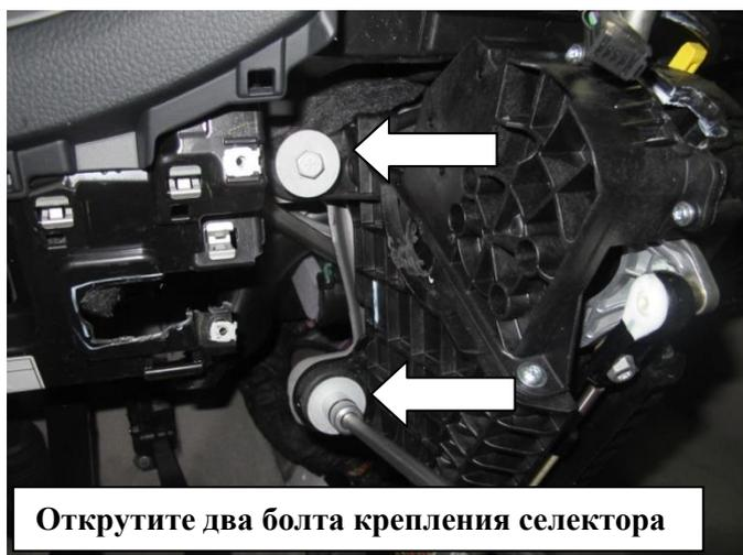
Открутите два болта крепления селектора
