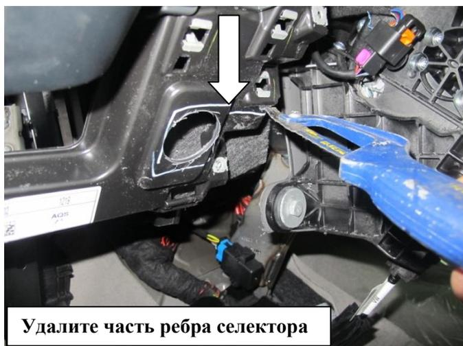
Удалите часть ребра селектора
