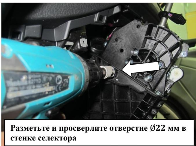
Разметьте и просверлите отверстие  $\varnothing 22$  мм в стенке селектора
