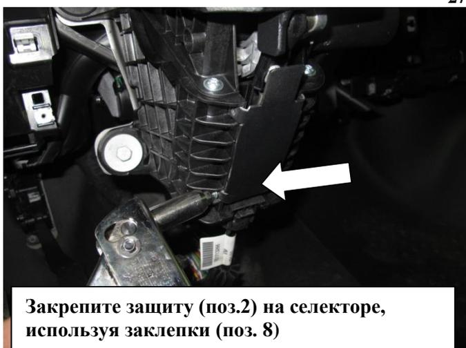
Закрепите защиту (поз.2) на селекторе, используя заклепки (поз. 8)
