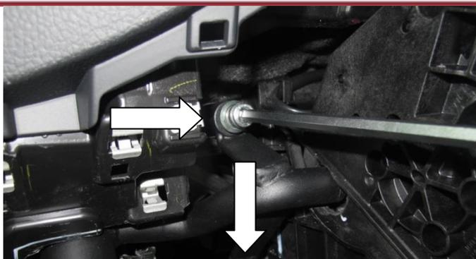
Установить замок (поз.1), закрепив винтами (поз. 4 и 5) и шайбами (поз. 6) при необходимости подложить шайбы (поз.7)
