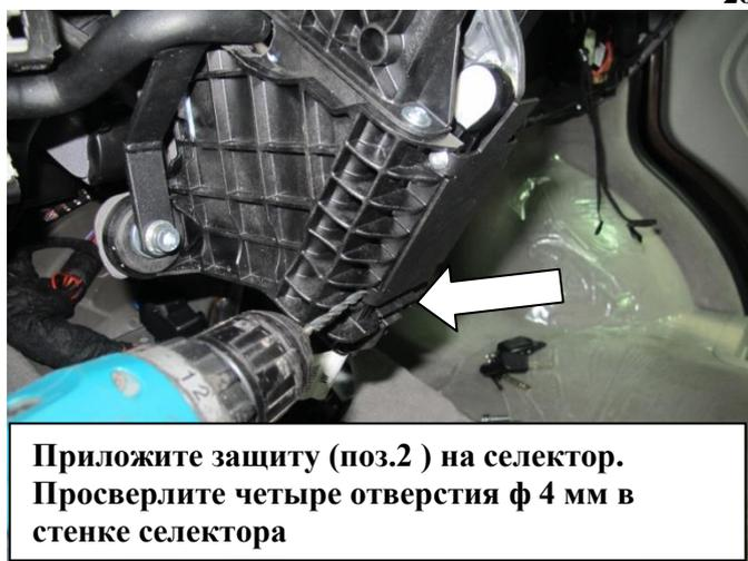
Приложите защиту (поз.2) на селектор. Просверлите четыре отверстия ф 4 мм в стенке селектора
