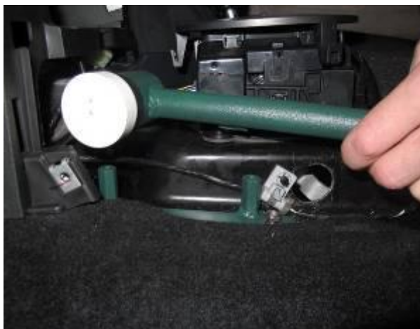
Закрепить замок с шаблоном на кронштейне
