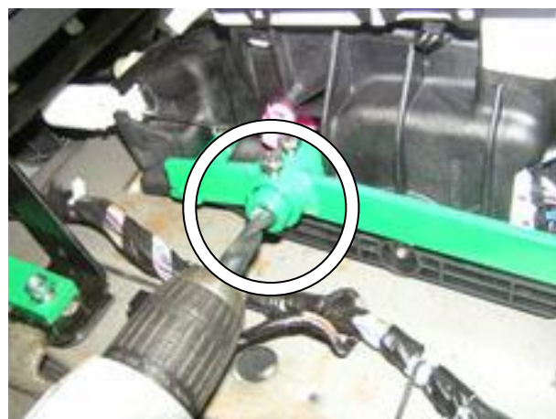
Просверлить отверстие в селекторе под трубу замка сквозь цилиндр кронштейна замка
