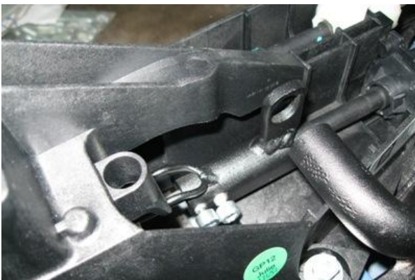
Перевести рычаг переключения передат в положение «R», произвести блокировку, отрегулировать положение хомута на тяге, сорвать винты
