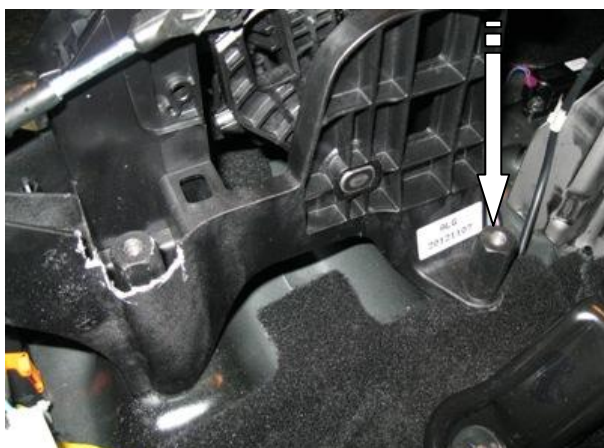
Открутить штатную гайку селектора, установить столбик 40 мм. на шпильку
