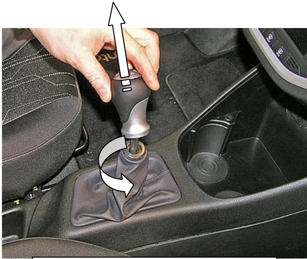
Открутить и снять рукоятку рычага переключения передач
