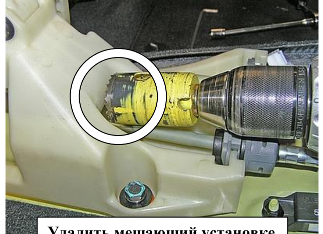
Удалить мешающий установке хомута пластик селектора
