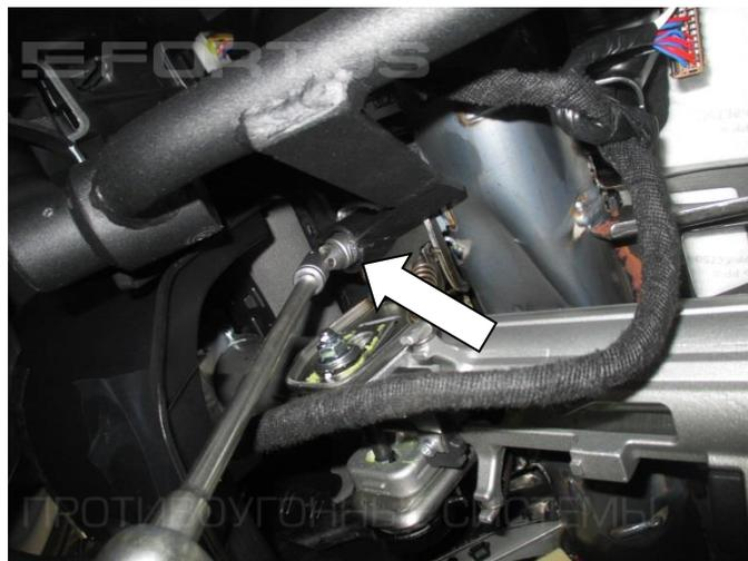
**14.** Закрепите замок (поз. 1) с помощью гайки (поз. 6)
