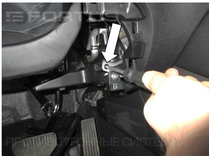
11. Открутите винт крепления патрубка воздуховода
