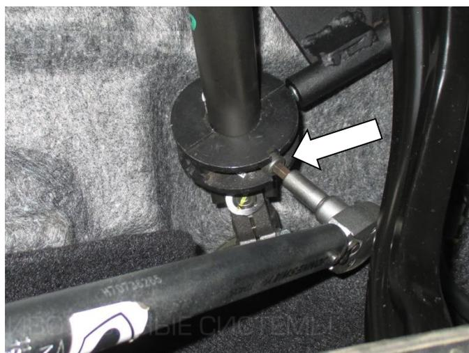
**16.** Закрутите болт (поз. 8) моментом 30 Н\*м. Проверьте работоспособность замка и рулевого вала
